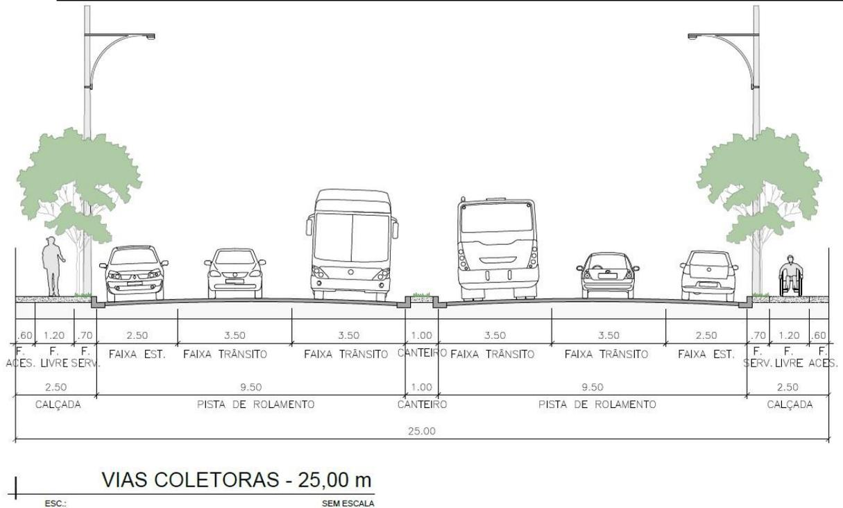
Figura 9: Seção Transversal das Vias Coletoras com Área Verde
