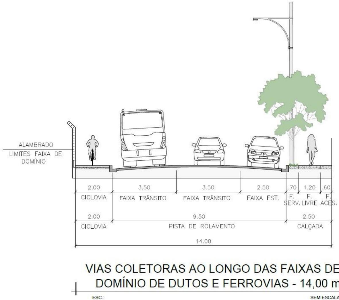
Figura 8: Seção Transversal das Vias Coletoras
